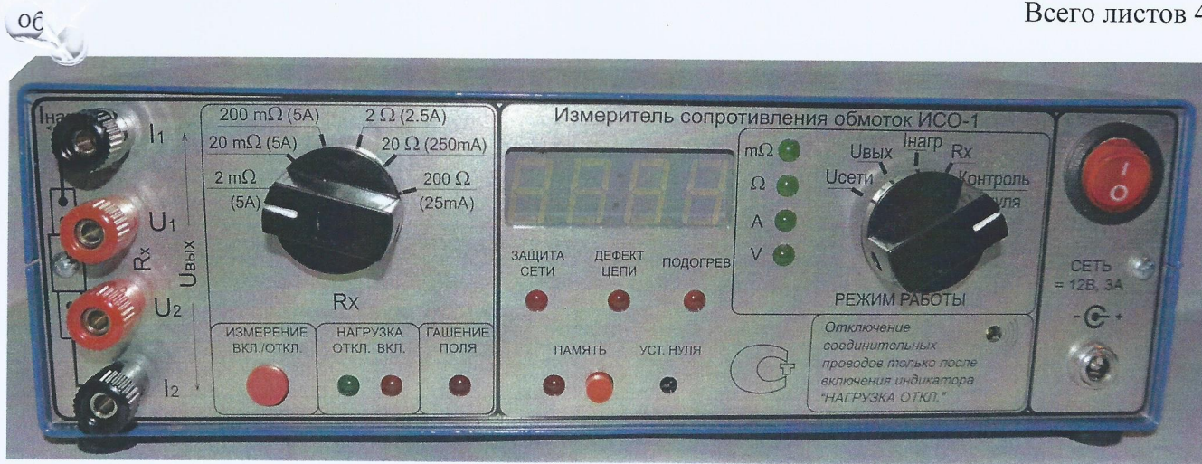
Рисунок 1 – Общий вид измерителей сопротивления обмоток ИСО-1. Вид спереди
